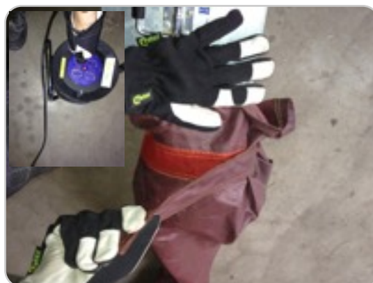
Stap 5: Sluit de luchtslang goed vast om de blower steek vervolgens de stekker in een geaard stopcontact.
